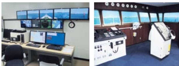
商船学科航海コースでは、2号館3階に実際の船の運動性能モデルを用いてコンピュータ上で船を動かす操船シミュレータを導入しました。このシミュレータは、模擬船橋をそなえ、多種多様な船舶の運転が体験できます。具体的には本校練習船「鳥羽丸」等から巨大タンカーの他、様々な海域、時間帯（昼間・薄暮・夜間）、環境（気象条件・波高等）、視点（自船の船橋からの視点、他船からの視点）等、臨場感あふれる操船を体験できます。また、隣の航法教室には他校に先駆けて23台の実習端末を含む教育・訓練用電子海図情報表示装置（ECDIS）を設置し、先に紹介した操船シミュレータとのデータ連携も出来ます。これらの装置の導入により、従前にまして学生の実習においても、知識の習得のみならず、安全な運航に対する技能と技術の向上等が期待されます。
