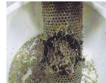
昭和45年当時、外航商船に乗船し、田子の浦港や広港に寄港した際、港湾が製紙会社の工場排水で海洋汚染し停泊中の船舶の発電機の冷却水システムに微細化した木材チップごみが取込まれ、冷却器が目詰りし始め温度上昇を招く事
